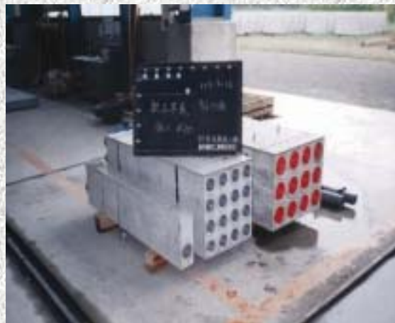
電纜管の検査
